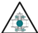
Si apretamos los tornillos con la válvula cerrada, el asiento será fijado en una posición inadecuada/deformada aumentando el par de maniobra. Abra la válvula completamente (Fig.8), asegurese que la tubería esté alineada y apriete del todo los tornillos de modo cruzado.
