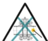
Les robinets ne doivent jamais être montés entre brides n'étant pas parallèles entre elles. Assurez-vous que les axes de la tuyauterie et de la vanne sont concentriques. Le papillon d'un robinet mal centré risque d'être endommagé (Fig. 5). Il est absolument interdit de faire des travaux de soudure sur la tuyauterie, le robinet étant entre les brides. Ceci endommagerait la manchette.
