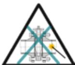
In nessun caso la valvola può essere installata tra flange che non siano parallele le une con le altre. Gli assi delle tubazioni e delle valvole devono essere allineati. Il disco di una valvola non allineata potrebbe venire danneggiato (Fig. 5). Inoltre è assolutamente inammissibile eseguire delle saldature sulle tubazioni mentre la valvola si trova tra le flange. Questo danneggerebbe il manicotto della valvola.
